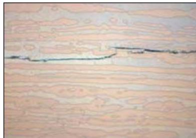
**Figura 8** - Falha típica de fragilização por hidrogênio (HENRIQUES, 2008)
