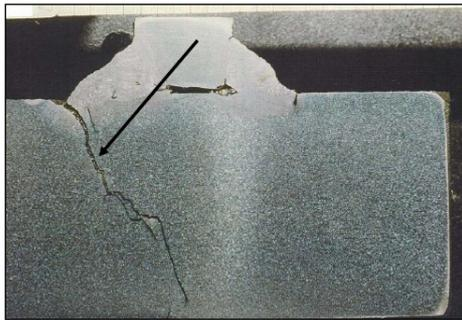
**Figura 4** – Falha típica provocada pelo fenômeno de corrosão sob tensão (HENRIQUES, 2008)
