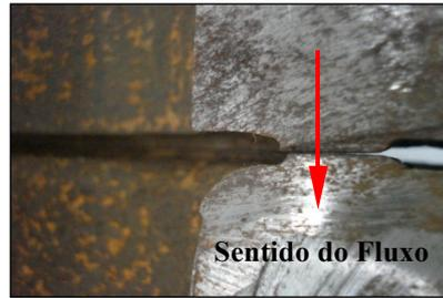
**Figura 7** – Arredondamento em face de flange provocada por cavitação (JESUS e BISCUOLA, 2011).
